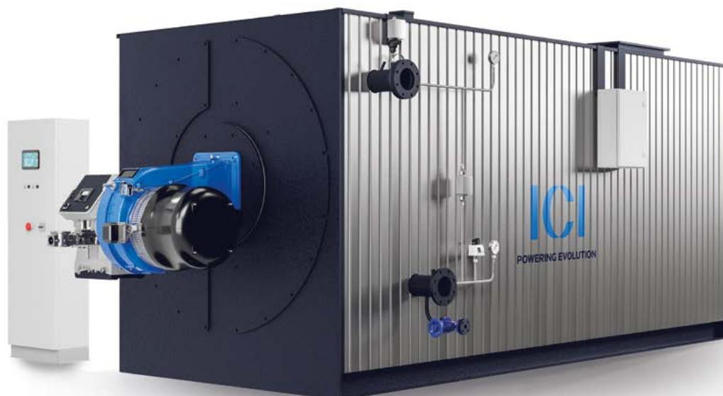
La gamme OPX présente des générateurs de chaleur à huile diathermique à trois parcours de fumée avec foyer à flamme traversante et sortie des fumées dans la partie arrière. Ce générateur de chaleur est conçu avec des faibles charges thermiques et des vitesses élevées de l'huile pour éliminer tout risque de « cracking » en offrant une fiabilité élevée contre les risques de surchauffe même en cas d'arrêt de la circulation de l'huile.
