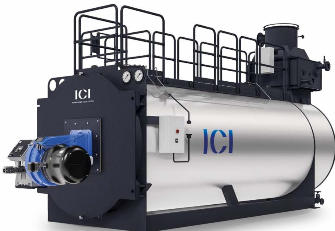
La gamme TNX présente des générateurs de chaleur à tubes de fumée à trois parcours effectifs avec boîte noyée à fonctionnement automatique, adaptés au fonctionnement avec combustibles liquides ou gazeux. Destinés à une utilisation dans les installations de chauffage de grandes dimensions, nécessitant de puissances comprises entre 3000 et 20 000 kW et des températures de fonctionnement entre 60 et 100°C., Les générateurs sont conçus pour une température maximale de sécurité de 110°C.
