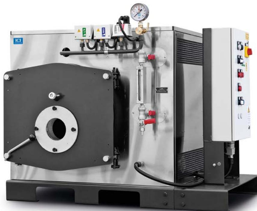
Generatori di vapore istantaneo a tubi da fumo a inversione di fiamma, completamente automatico, ad alto rendimento. Il basso contenuto d'acqua e le ridotte misure di ingombro li rendono i generatori di vapore più indicati per tutti i piccoli e medi utilizzi in cui è necessario vapore con titolo elevato e ridotto impegno per la conduzione della centrale termica.
