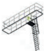
Scala e corrimano per accesso alla sommità della caldaia ( solo modelli STX 10-12, 15-20, 25-30 )
