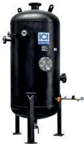
Il serbatoio raccolta spurghi BDV è stato progettato per trattare i fanghi che normalmente depositano sul fondo delle caldaie a vapore; questi spurghi vengono raffreddati e fatti decantare sul fondo del serbatoio prima di essere scaricati in fogna limitando rischi all'operatore e danni ambientali. Il serbatoio raccolta spurghi è conforme alla Direttiva PED 2014/68/EU Completo di :
